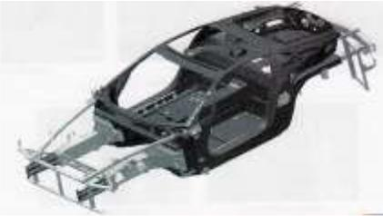
CFRPの自動車パネルへの適用
