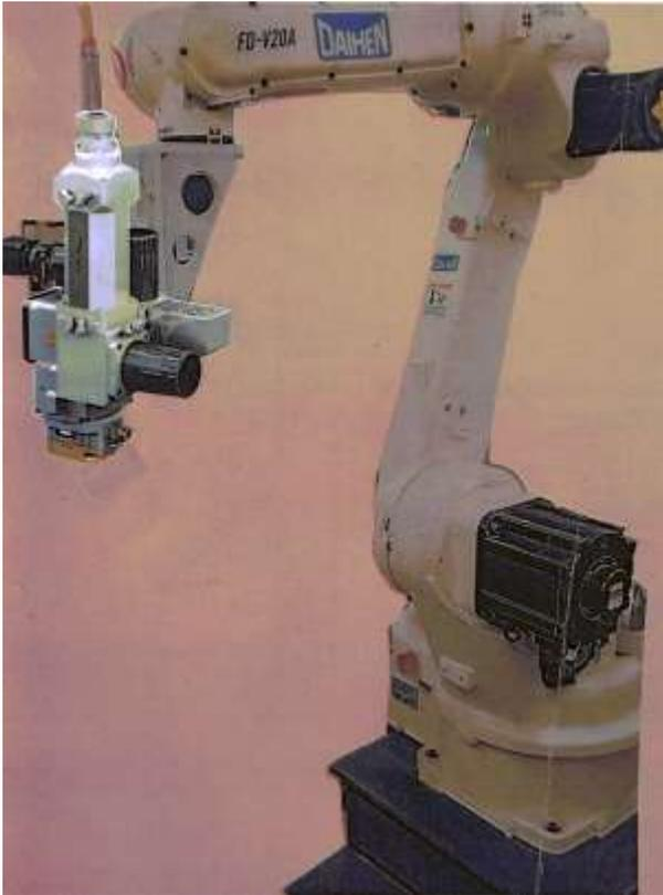
多関節ロボットとワブリング溶接ヘッド
